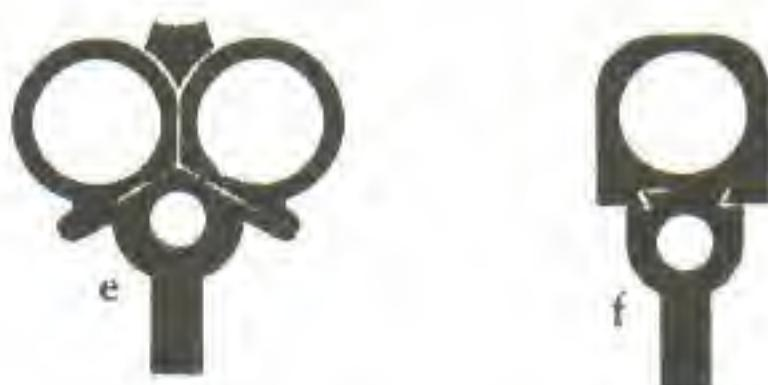
Kod najvećeg broja pušaka cijevi su letovane cijelom dužinom, ali ima pušaka gdje su cijevi samo djelimično spojene, a kod nekih je spajanje izvršeno samo u zadnjem dijelu koji se spaja sa baskulom i na vrhu jednim prstenom koji omogućuje slobodno vibriranje i rastezanje cijevi pri pucanju i zagrijavanju kao i mijenjanje položaja jedne cijevi u odnosu na drugu u cilju što boljeg međusobnog poklapanja posipa obe cijevi.
